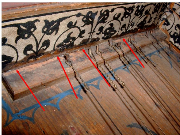
Afbeelding 20. Zichtbare epoxy-lijm op het Couchet-virginaal. Foto Karel Moens.
