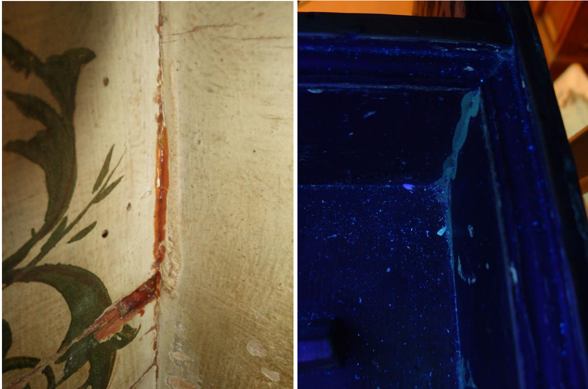
Afbeelding 24. Zichtbare epoxy in het Dulcken-clavecimbel, Museum Vleeshuis, AV.1967.001.015. Foto's van Karel Moens.
