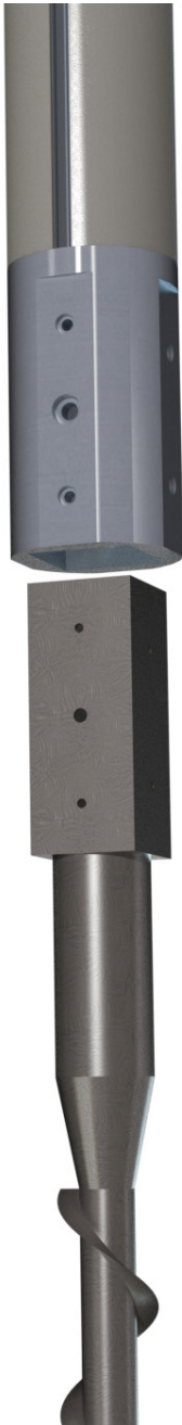
Figuur 70: close-up verankering
