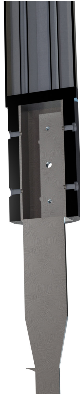
Figuur 71: doorsnede bevestiging spiraalpen
